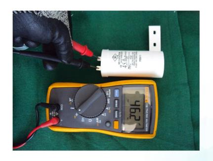
Colocar puntas de multímetro en terminales de capacitor. Resultado: 45-50 µF +/- 5%
